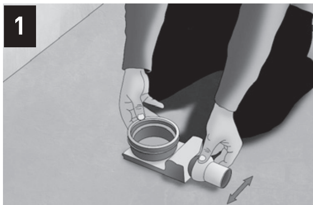
1 Установка S-основания на пол ванной комнаты в соответствующее положение
