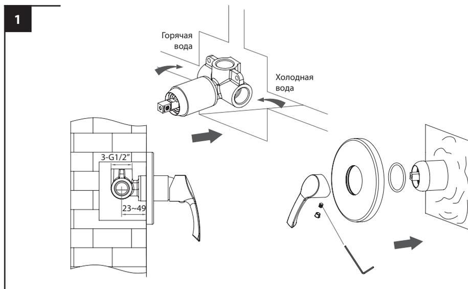
1. Подготовьте в стене каналы для размещения в них узлов смесителя и соединительной арматуры (в комплект не входит);
