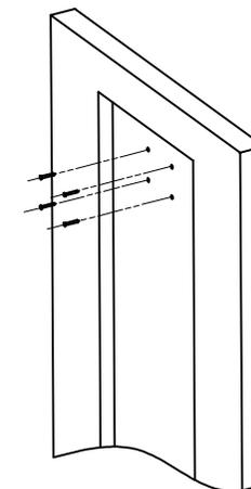
3. Закрепите пластину и скрытую часть винтами.
