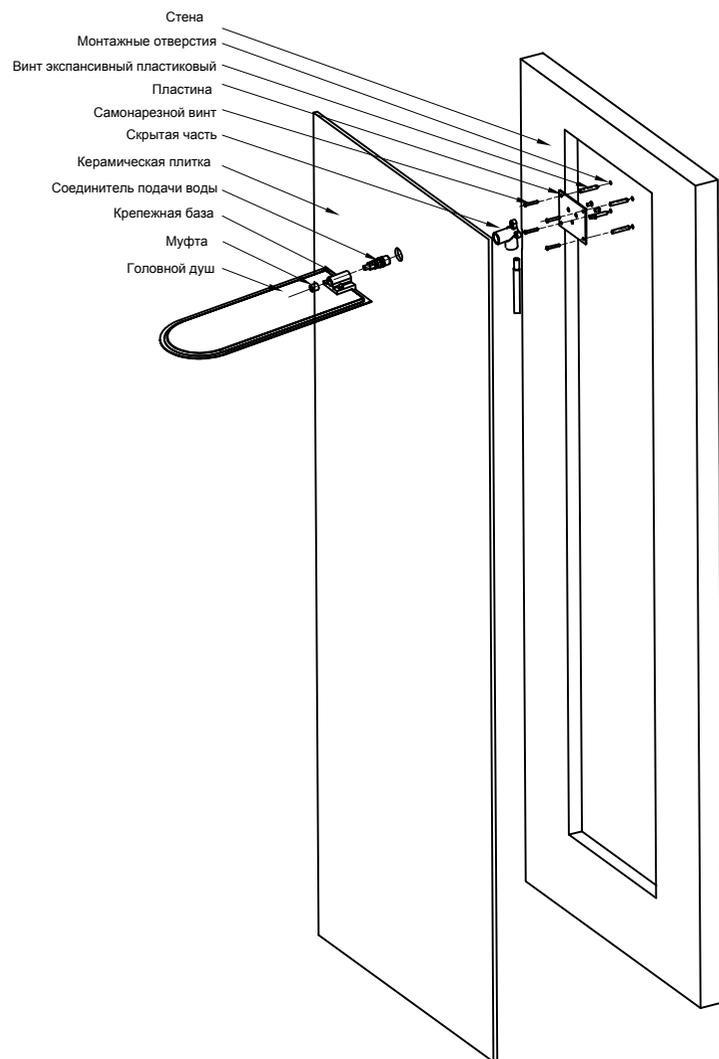
1. Сделайте нишу в стене с глубиной 57 мм. Сделайте 4 отверстия в нише диаметром 8 мм и длиной 30 мм
