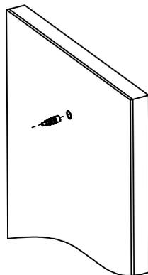
8. Направьте головной душ на соединитель для подачи воды, используйте шестигранный гаечный ключ, чтобы завинтить его, пока головной душ не станет устойчивым.
