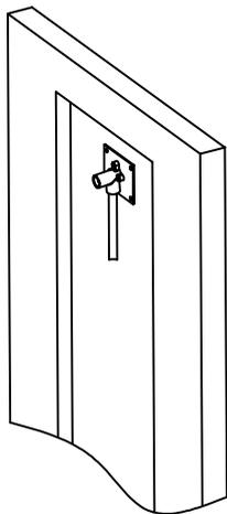
6. Просверлите круглое отверстие диаметром 22 мм. (Глубина отверстия зависит от встроенной коробки)
