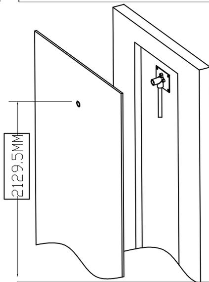
7. Вставьте винт для подачи воды во встроенную коробку с глубиной 22 мм. (ВНИМАНИЕ: проверьте отсутствие утечки)
