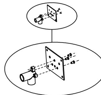
4. Используйте самонарезные винты, чтобы соединить скрытую часть пластины в стене.
